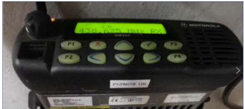
De Motorola mobilfoon hier in gebruik als ontvanger op 438.625MHz.
