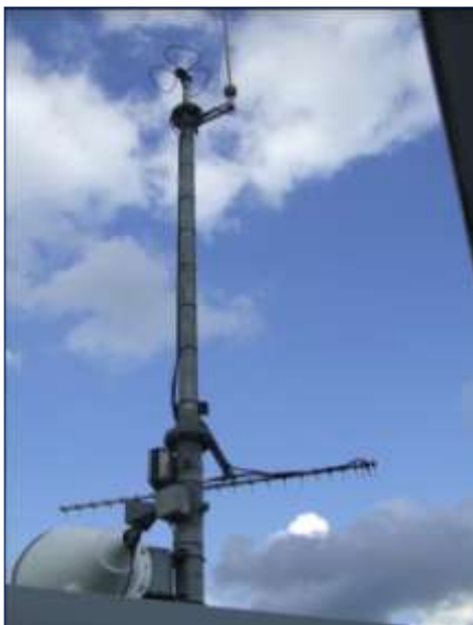
Nieuw deel van flens tot flens met topdeel NO mast
