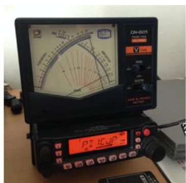
De SWR van antenne 1 is 1:1.02
